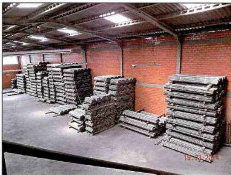
Vista dos tubos de aço galvanizado de vários tamanhos para montagem de andaimes.
